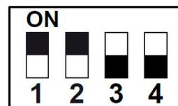
1. Estando el collar **apagado**, coloque los interruptores tal como aparecen en la figura 8.
