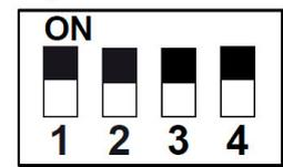
1. Estando el collar **apagado**, coloque las **cuatro pestañas** en posición **ON** (figura 10).
