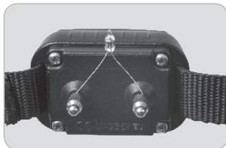
Colocación de la lamparita de comprobación
